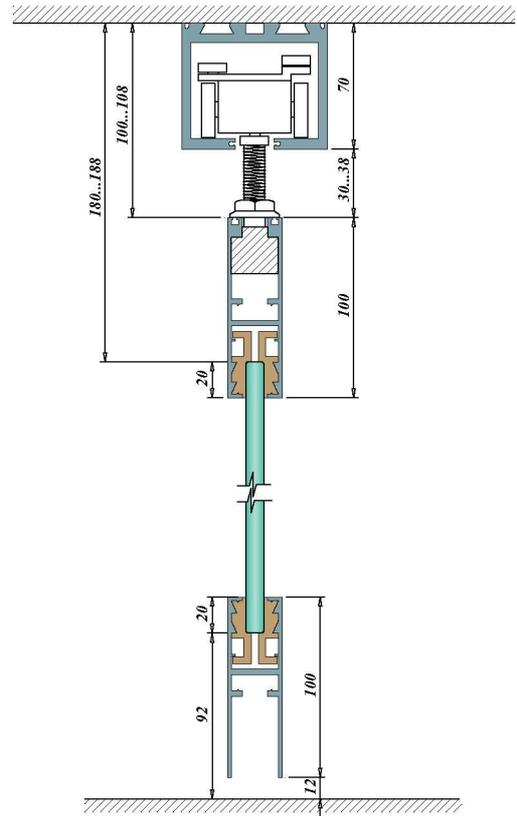
**SWS-DR с дверным профилем с щеточным уплотнителем**
